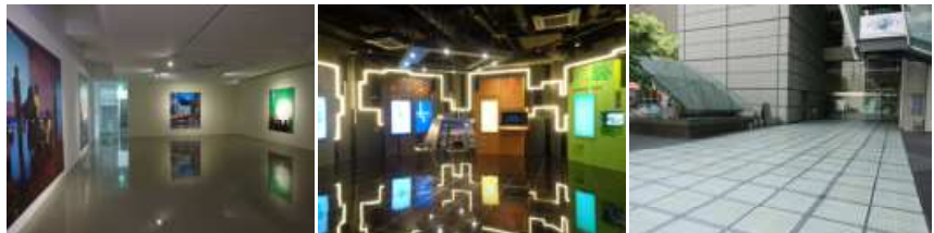
지양: 미끄러운 고풍택 재료를 사용하여 안전사고 발생 우려 지양: 야외공간에 유리바닥재 설치
