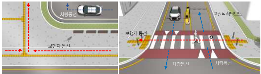
권장: 보행자와 차량의 동선이 분리된 접근동선 권장: 보행자와 차량의 교행구간에 고원식 횡단보도 조성
