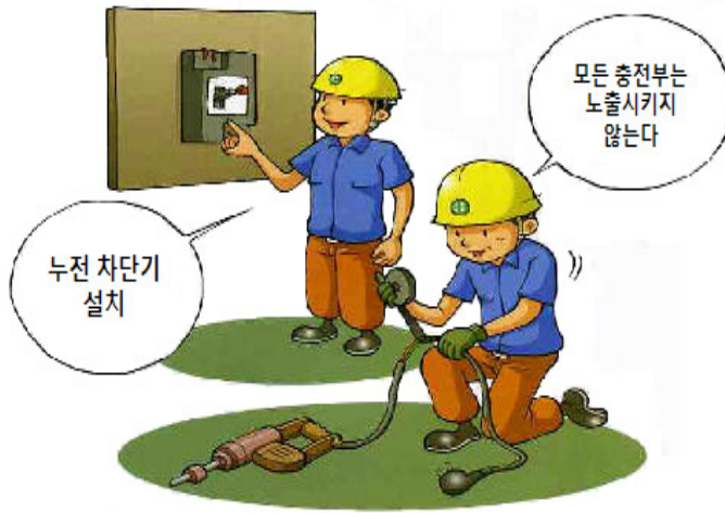
|| 그림 64 누전차단기 설치 및 충전부 마감처리 예 ||
