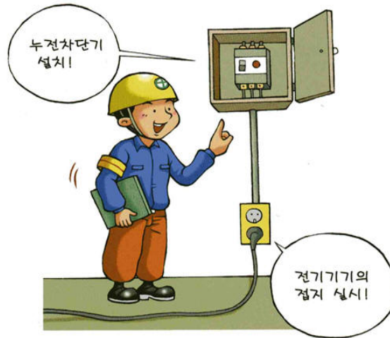
|| 그림 65 누전차단기 설치 예 ||
