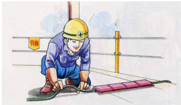
|| 그림 68 배선 보호 덮개 설치 예 ||
